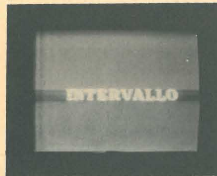
Fig. 7 - L'immagine è più piccola del normale sia nel senso dell'altezza che nel senso della lunghezza. Si nota il suono nell'immagine.
